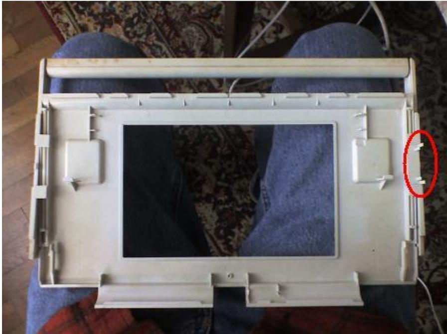
Et la partie arrière avec l'écran. Flèche en **rouge** de la partie où s'incère les 4 dents ci-dessus. Ensuite, il suffit juste de d'éclipser l'écran de la face arrière avec les clips entourés en **bleu**.
